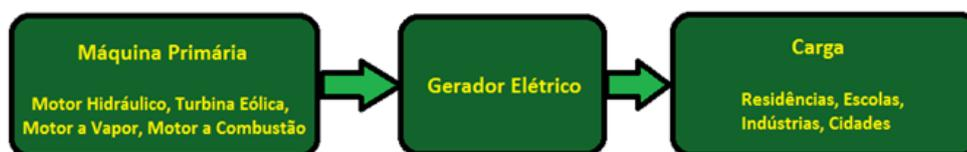
Figura 2.29 - Esquema simplificado de GMG.
